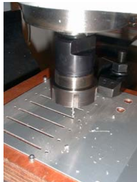
Rechts Beim Fräsen der Schlitze in das Gehäuse des JEZ -Mischpultes
